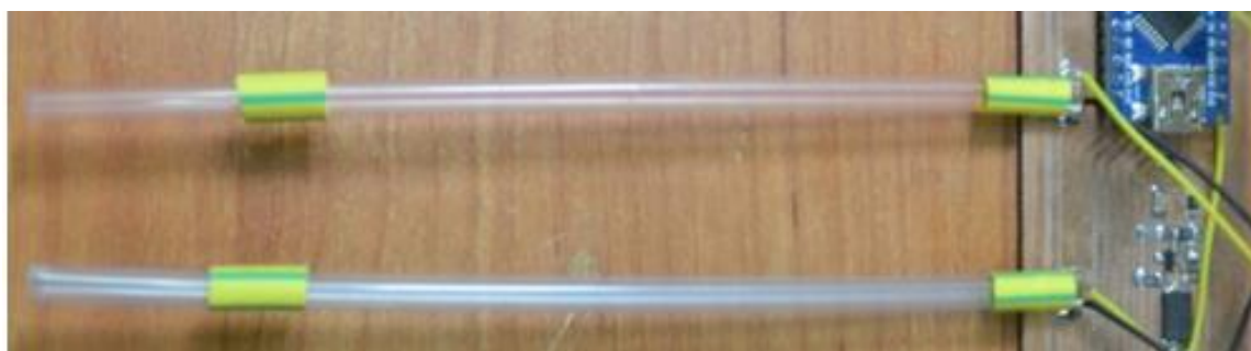
Рисунок 2 – Фотография прозрачной полимерной трубки со вставленным внутрь светодиодом, ось трубки и оптическая ось источника света совпадают
