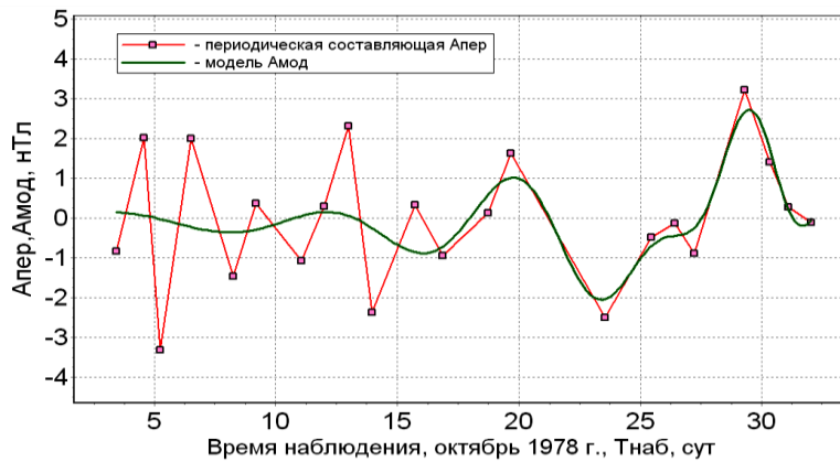
Рисунок 10 – Аппроксимация периодической составляющей A_{ПЕР} аномалии магнитного поля, зафиксированной накануне Алайского землетрясения, ее моделью A_{МОД}
