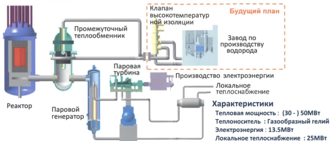
Рисунок 1 – Принципиальная схема АЭС с реактором КНТР
