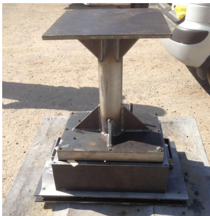
Рисунок 3 – Модернизированная пресс-форма в сборе
