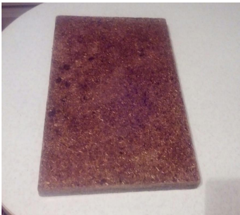
Рисунок 5 – Образец плитного материала, полученного на модернизированной пресс-форме
