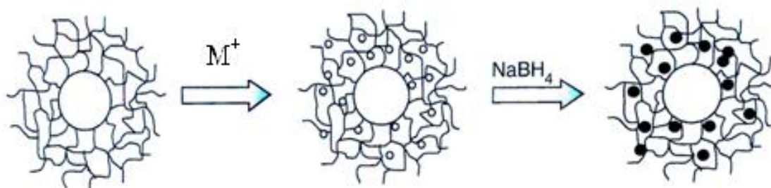
Рисунок 17 – Синтез наночастиц металла в мицелле с ядром полистирола и оболочкой из шитого полиизопрпилакриламида
