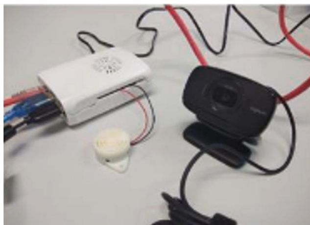
Рисунок 8 – Результат подключения Raspberry Pi 3 к зуммеру и веб-камере
